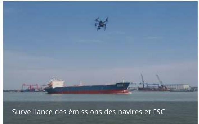
Faites voler Sniffer4D dans les panaches des navires et il peut automatiquement estimer la teneur en soufre du carburant (FSC) des navires en utilisant son algorithme d'inversion intégré.
